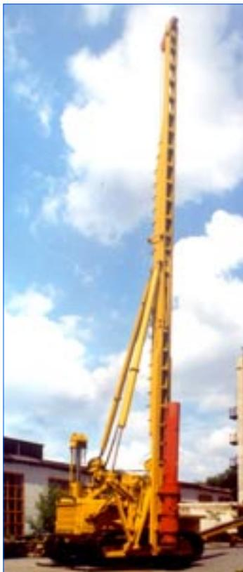
Предназначен для погружения вертикальных и наклонных железобетонных свай дизель-молотами типа СП-76.
